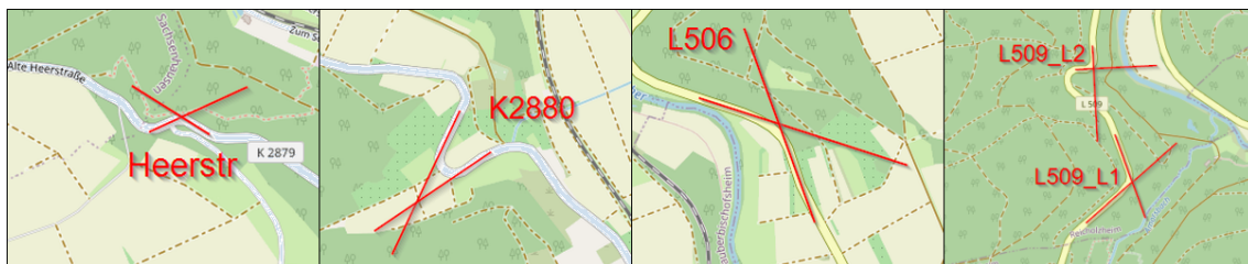
Abbildung 4.9. Kartendarstellung der selektierten Kurven mit Umschlingungswinkeln (rot)
