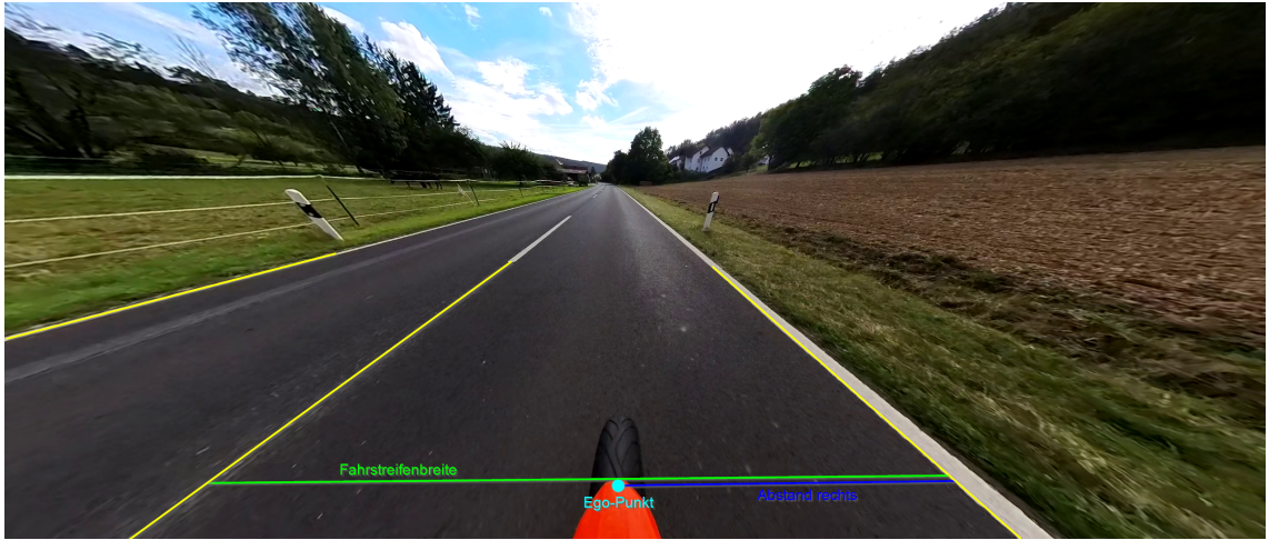
Abbildung 4.12. Berechnung Querversatz: Fahrbahnmarkierungen (gelb), Ego-Punkt (türkis), Fahrstreifenbreite (grün), Abstand zum rechten Fahrbahnrand (blau)
