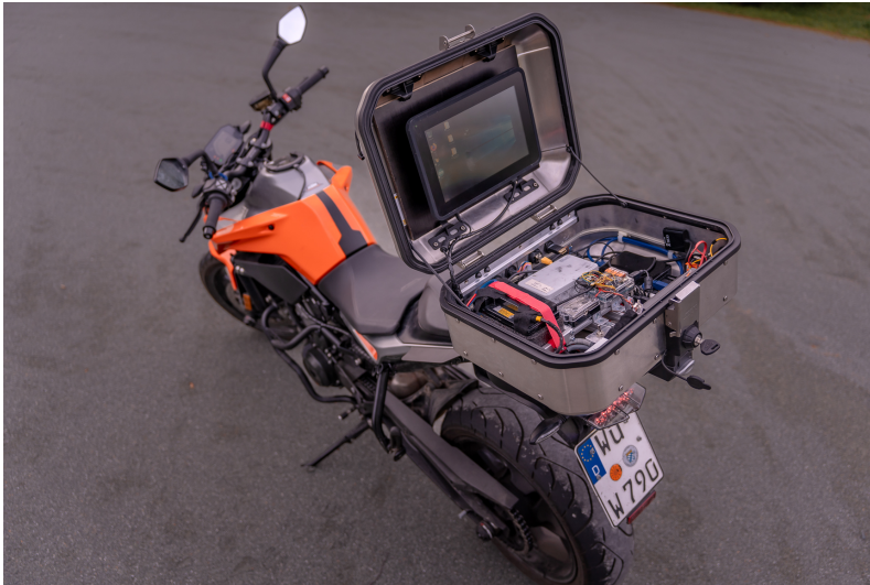
Abbildung 3.2. Messmotorrad KTM Duke (WIVW GmbH)
