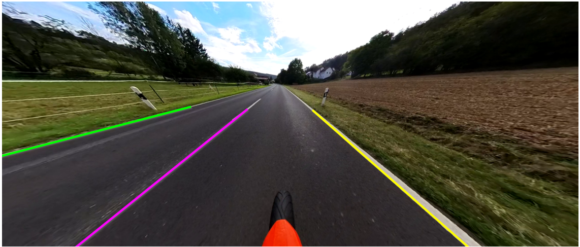
Abbildung 4.8. Beispiel CLRnet prediction mit rechtem Fahrbahnrand (gelb), linkem (grün) und Mittelstreifen (magenta)
